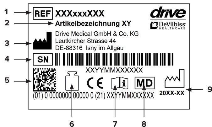
1 Référence | 2 Désignation | 3 Fabricant | 4 N° de série | 5 Code UDI | 6 Charge maximale | 7 Se conformer au mode d'emploi | 8 Dispositif médical | 9 Date de fabrication (année-mois)
