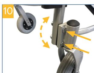
**Zorg ervoor dat u de schroeven na het instellen stevig aandraait en controleer of ze goed vast zitten!**
