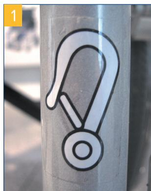
Of uw rolstoel is goedgekeurd als zitplaats in een motorvoertuig voor het vervoer van personen met een mobiliteitsbeperking (KMP) kunt u zien aan het haaksymbool (**afb. 1**) op de rolstoel of lezen in deze gebruiksaanwijzing, hoofdstuk Vervoer in motorvoertuigen voor het vervoer van personen met een mobiliteitsbeperking (KMP).
