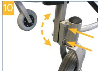
Il est alors possible de tirer le châssis vers l'avant jusqu'au trou suivant (en tout 3 fois) avant de remettre les vis.
