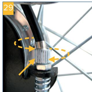
Lösen Sie zur Einstellung zuerst die Kontermutter und führen Sie dann die entsprechende Einstellung durch, danach die Kontermutter unbedingt wieder anziehen, halten Sie dabei mittels einer Zange die Einstellschraube fest. Zum Bremsen des Rollstuhles durch die Begleitperson ziehen Sie beide Bremsgriffe an die Griffe heran.
