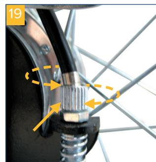
Per la regolazione, svitare il controdado ed eseguire la regolazione desiderata, quindi stringerlo nuovamente, tenendo ferma contemporaneamente la vite di regolazione con una pinza. Per frenare la carrozzella, l'accompagnatore deve tirare verso di sé le due manopole del freno.
