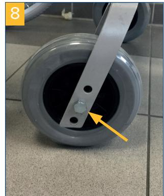
De afsluitingen van de verschillende openingen zijn gemakkelijk te verwisselen. Zet het wiel nu in de gewenste positie, breng de schroef van de wielas weer aan en draai deze vast (**afb. 8**).
