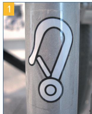
Pour savoir si votre fauteuil roulant est autorisé ou non à être utilisé comme siège dans un véhicule automobile pour le transport de personnes à mobilité réduite (PMR), vous pouvez voir le symbole du crochet (**fig. 1**) sur le fauteuil roulant ou consulter le chapitre Transport dans des véhicules automobiles pour le transport de personnes à mobilité réduite (PMR) de ce manuel d'utilisation.
