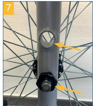
**Verificare che l'asse delle ruote sia serrato a fondo!**
