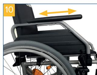
Zum Wegschwenken der Armlehne nach hinten, betätigen Sie den Entriegelungshebel vorn an der Armlehne und halten diesen, bei gleichzeitigem hochziehen der Armlehne, gedrückt bis die Armlehne frei ist. Nun kann sie nach hinten weggeschwenkt werden (**Bild 11+12**).
