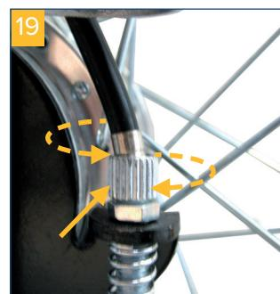
Lösen Sie zur Einstellung zuerst die Kontermutter und führen Sie dann die entsprechende Einstellung durch, danach die Kontermutter unbedingt wieder anziehen, halten Sie dabei mittels einer Zange die Einstellschraube fest. Zum Bremsen des Rollstuhles durch die Begleitperson ziehen Sie beide Bremsgriffe an die Griffe heran.
