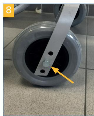
Die Stopfen der entsprechenden Bohrungen sind leicht austauschbar. Versetzen Sie das Rad nun in die gewünschte Position und stecken Sie die Radachsenschraube wieder ein und ziehen diese fest (**Bild 8**).
